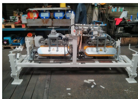
Châssis pour recevoir 2 transporteurs de câbles
